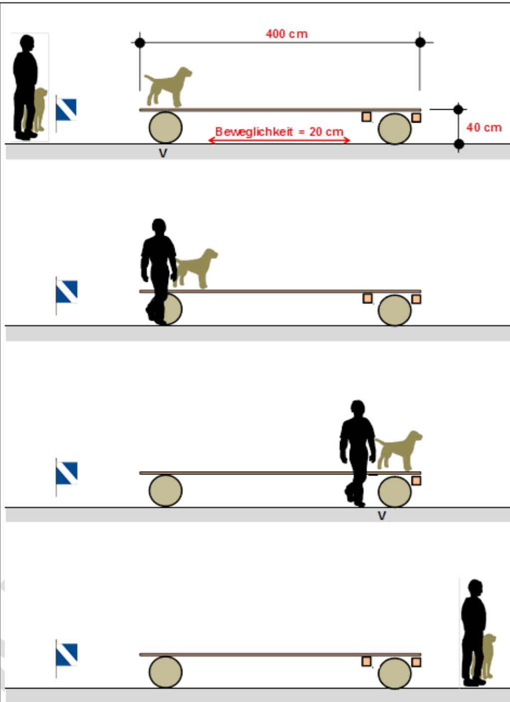
Die bewegliche Fassbrücke besteht aus zwei gleich großen Fässern  $D = 40\text{ cm}$  und einem Brett Länge ca. 4 m, Breite ca. 30 cm. Die Konstruktion muss so ausgeführt sein, dass sich das Brett um ca. 20 cm verschieben kann.
